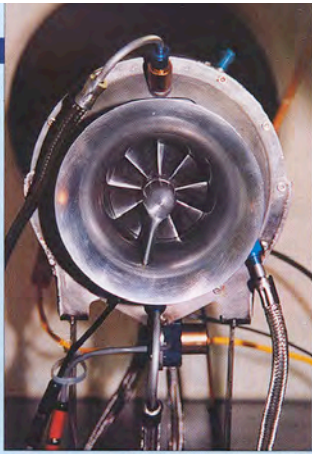
SR30 von vorne: Die Turbine ist klein, leistet aber 422 N.
