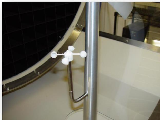
**Wind Speed Anemometer**
